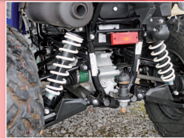
Langhubig: Einzelradaufhängung, Querstabilisator
